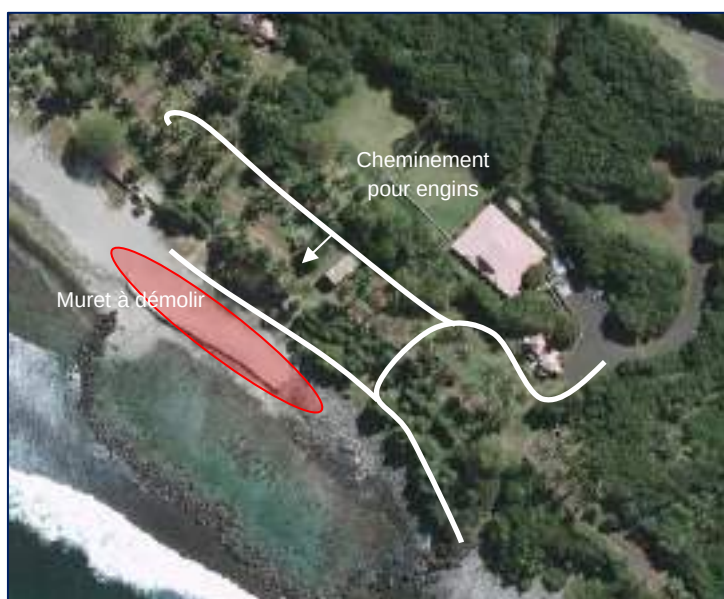
Figure 57 – Muret à démolir
