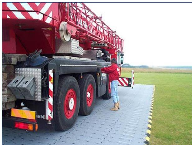
Figure 239 – Exemple de bande de roulement provisoire sans matériaux d'apport
