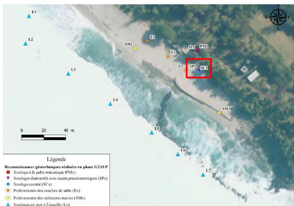
Figure 6: Localisation des sondages géotechniques
