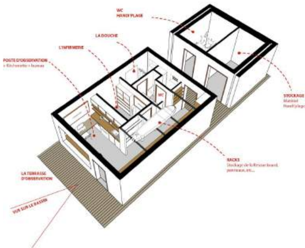
Figure 12 : Solution retenue pour l'agencement du local de surveillance
