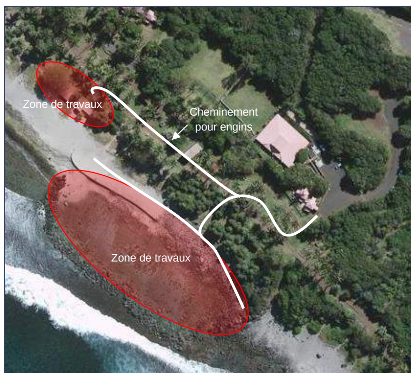
Figure 50 – Pistes d'accès aux zones d'intervention
