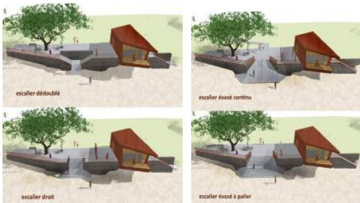
Figure 14 : Propositions initiales de design de l'escalier d'accès
