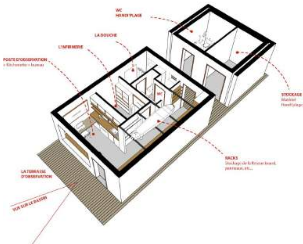
Figure 198 : Solution retenue pour l'agencement du local de surveillance
